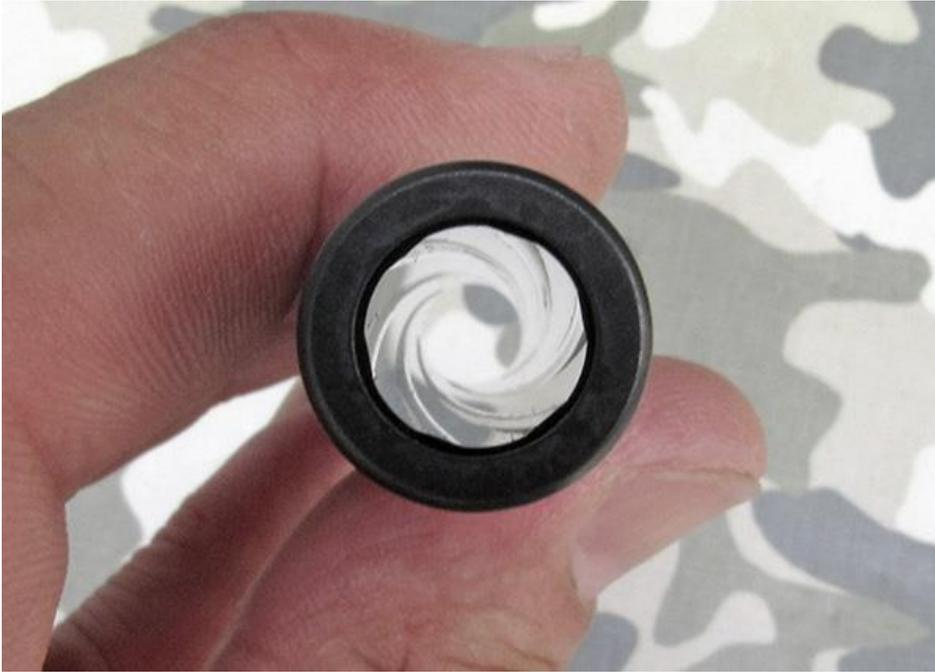
Interno della canna di una Glock 17. La rigatura poligonale “gentile” con il proiettile ha i pieni dai profili arrotondati.
