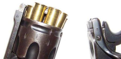
Un Webley Mark III, lo si legge sul profilo del Top – strap. La fase di espulsione è sempre quella, un'apertura totale del telaio come accade nel primo
