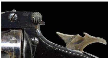
Il comando manuale che consente l'apertura del telaio: Top – break. Notare la presa di sinistra tonda e zigrinata. Il cane esterno, armato, installa il percussore. Foto: [poulinauctions.com](http://poulinauctions.com)
