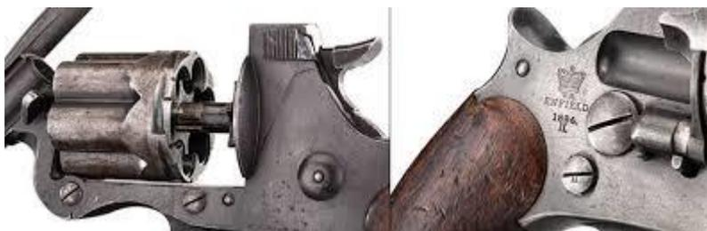
Nella foto a sinistra è possibile notare il comando di svincolo Top – strap, ha una forma più o meno rettangolare e superficie intagliata da linee verticali. A destra si intravede lo sportellino di caricamento chiuso e l'impronta/inserimento bossolo. È la Versione successiva Mark II prodotta nel 1881 dotata del mirino arrotondato all'apice: lo scopo è quello di eliminare impigliamenti vari durante estrazioni rapide – abiti o fondina – in situazioni d'emergenza. Foto: NRA.com
