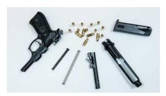
La Beretta 92 FS cal. 9 Parabellum smontata. A partire da sinistra: il fusto nel suo insieme, la molla di recupero singola, la canna con il blocchetto oscillante sotto la camera di cartuccia, il carrello otturatore e il caricatore. In alto, al centro, i 15 colpi.
