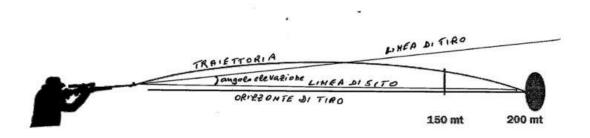
Portata utile. Il tiro viene effettuato con una lieve inclinazione/angolo di elevazione. Il proiettile traccia una traiettoria curvilinea, raggiungendo il bersaglio con le prestazioni balistiche ancora alte alla distanza di 200 metri.
